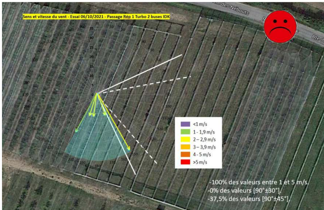
Figure 14 : Rose des vents pour la répétition 1 avec buses IDK
