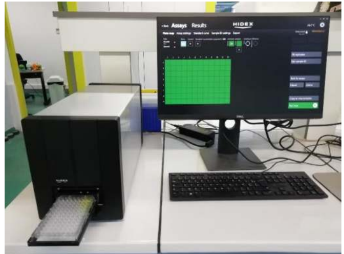
Photo 7 : lecture de plaque au spectrophotomètre
